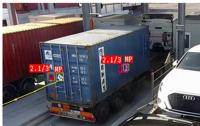
Le avanzate tecniche di intelligenza artificiale che elaborano le immagini provenienti da telecamere opportunamente posizionate presso i varchi stradali garantiscono il rilevamento e l'identificazione delle targhe IMO posizionate sugli automezzi con la massima affidabilità e precisione, senza la necessità di presidiare fisicamente i varchi, con una sensibile riduzione dei tempi necessari all'espletamento delle procedure di transito.
