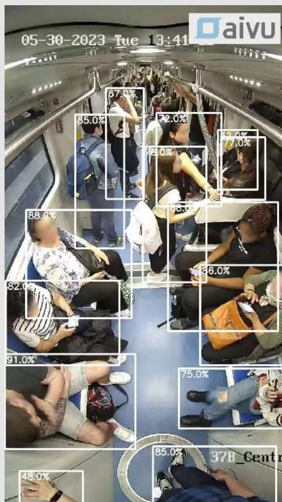
Nelle immagini: la soluzione di people counting e il flow management per il progetto di ricerca *More Than This*. Gli algoritmi di video analisi sviluppati da Aitek elaborano le immagini provenienti dalle telecamere posizionate in banchina (a sinistra) e a bordo treno (a destra).
